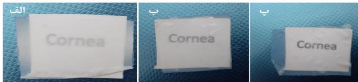
تصویر 4- بررسی و مقایسه میزان انتقال نور داربست‌های الکتروریسی، پلی کاپرولاکتون (الف)، پلی کاپرولاکتون/پلی وینیل الکل (ب)، پلی کاپرولاکتون/پلی وینیل الکل/عصاره آلونهورا (پ)
